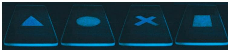
**Beleuchten eines mechanischen Ereignisses:** Filme eines Polymer-Rotaxan-Konjugats wurden auf Quarzplättchen gegossen und mit Aluminiummasken bedeckt; die nichtabgedeckten Flächen wurden DMSO-Dampf ausgesetzt. Das Lösungs-
